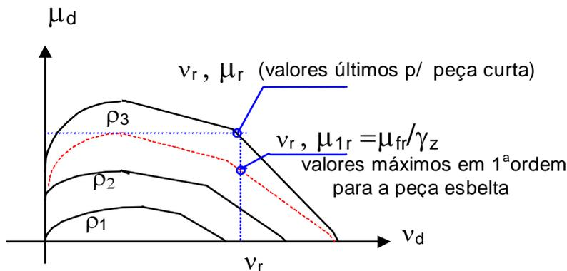
**Figura C - Diagrama de interação ( $v \times \mu$ ) resistentes - considerada a esbelteza da peça pelo modelo proposto**
