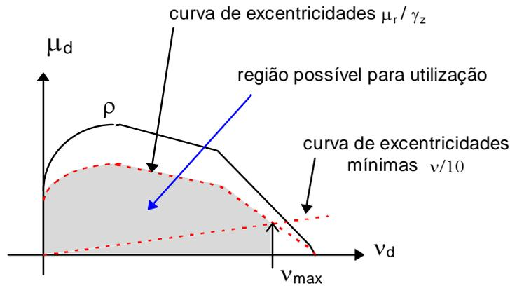
Figura D - Diagr. de interação ( $v \times \mu$ ) resistentes - visualização da região do diagrama para pares ( $v \times \mu$ ) possíveis em 1ª ordem para uma taxa de armadura,  $\rho$ , pré-definida.
