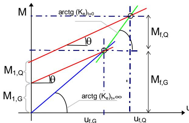
Portanto, é possível se desacoplar os processamentos para cargas verticais quase-permanentes e para as ações do vento, por exemplo, determinando separadamente seus respectivos coeficientes de instabilidade e simplesmente sobrepor os efeitos multiplicando cada carregamento por seus correspondentes coeficientes.
