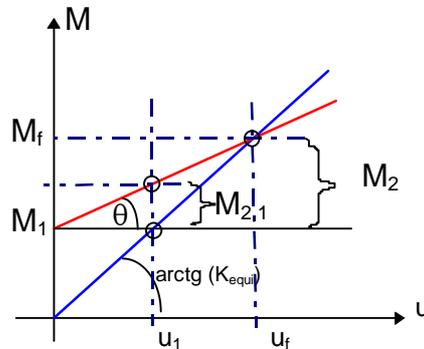
Figura E - Diagr. Momento total na base do pórtico x deslocamento horizontal de controle
