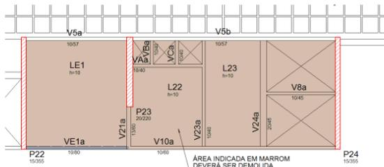
Figura 5. Trecho a ser demolido
